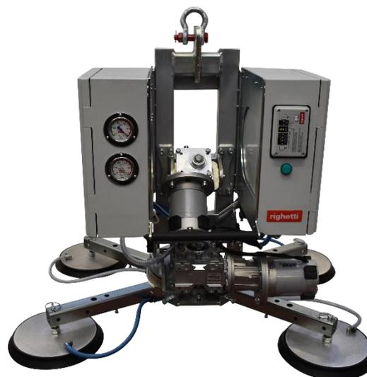
Il modello **VB4 RCEBE** è un sollevatore a 4 piastre d.310 mm e con portata massima di 400 kg. Le **piastre aspiranti sono spostabili** per poter ampliare l'ingombro della presa, e grazie ai braccetti aggiuntivi permettono di raggiungere **quattro diverse posizioni**, di cui una in linea per vetri lunghi e stretti. La ventosa è **alimentata da batterie incorporate**, ricaricabili ed estraibili in modo facile e veloce. Il sollevatore viene fornito completo di caricabatterie.
