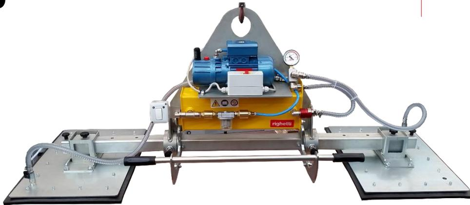
La serie di sollevatori a ventosa M2EB comprende i modelli di ventose per lastre di marmo a due piastre in linea, con portata che va da 250 kg a 1500 kg. La serie M2EB crea il vuoto grazie ad una pompa elettrica posizionata sulla struttura del sollevatore, può essere alimentata a 220V monofase o 400V trifase. Il sistema di **basculamento manuale 0 – 90°** permette un movimento del carico da verticale in orizzontale e viceversa.
