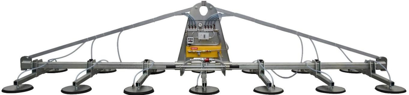
F14EB 4200 è un sollevatore a ventosa ad alimentazione elettrica, perfetto per uso su carroponete o gru a bandiera. Il sollevatore F14EB 4200 ha un **telaio fisso in orizzontale e 14 ventose di diametro 390 mm**, distribuite su 7 braccetti con lunghezza 1410mm. La **posizione delle ventose e dei braccetti è modificabile** in base alla forma e dimensione del carico da sollevare.
